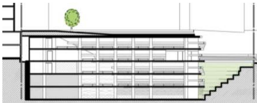
Рисунок 1.41 - Поперечный разрез паркинга [24]
