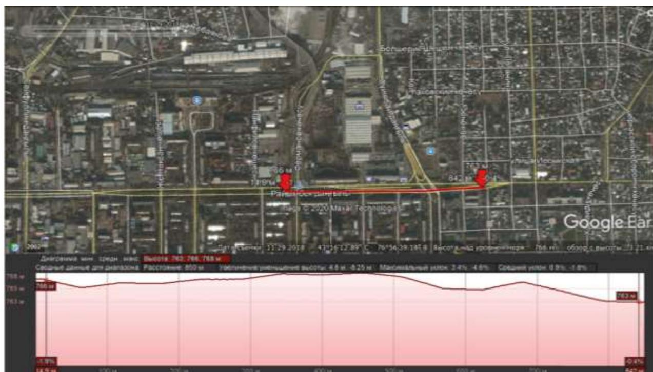
Рисунок 1.3 - Сечение рельефа с запада на восток. Перепад рельефа составляет 5 метров [11]
